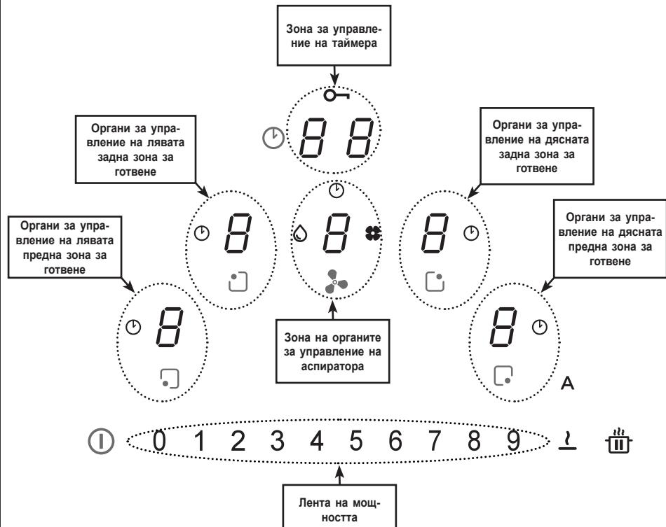
Органите за управление на зоните за готовене, аспиратора и таймера се активират с натискане на съответния цифров разред **B**.
