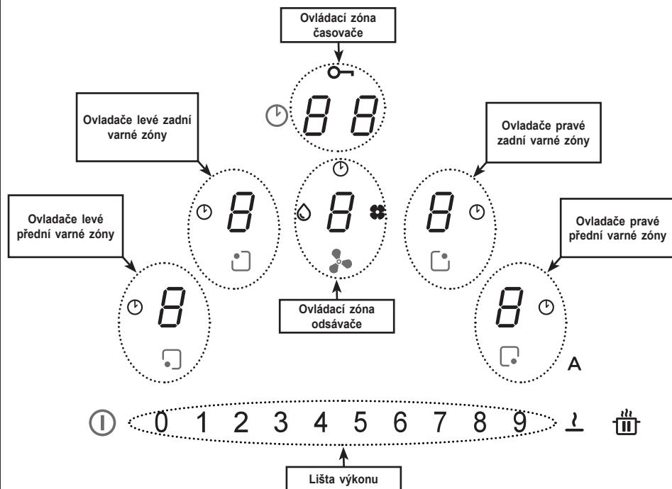
Ovladače varných zón, odsávače a časovače lze aktivovat stisknutím příslušného Digitu **B**. Potvrzení je dáno intenzivním rozsvícením Digitu.
