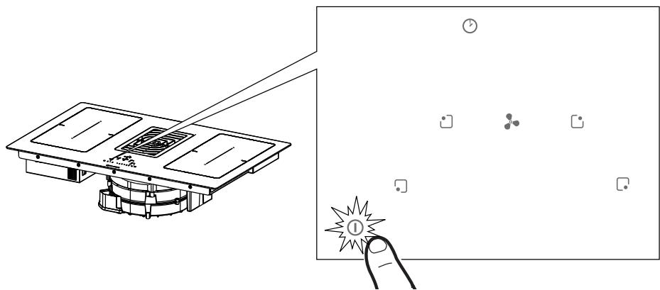
Натиснете и задръжте бутона за включване/изключване **I** за 2 секунди, за да включите плота и да активирате функциите му. Всички цифрови разреди показват **B.**, а цифровите разреди на таймера показват „**C L**“.
