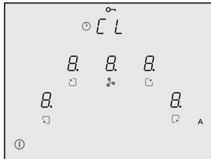
Platenoppen er nå slått på, men effektnivået for kokesonene og kjøkkenviften er på null. Platenoppen slås av automatisk etter 20 sekunder uten bruk.
